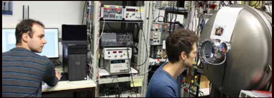
Die wissenschaftlich-technischen Teams am MPS nutzen die verbleibenden Wochen bis zum Start von JUICE unter anderem für Kalibrationsmessungen wie hier mit Hardwarekomponenten von PEP-JEI.
