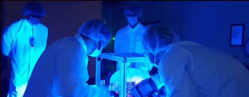
Kurz vor der Auslieferung von SWI nach Toulouse 2021 prüfen die wissenschaftlich-technischen Teams am MPS im ultravioletten Licht, dass keinerlei Staubteilchen das Instrument verunreinigen. © MPS
