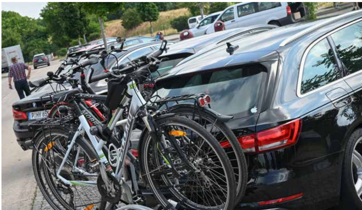
Das schwere E-Bike muss auf jeden Fall mit in den Urlaub? Dann eignet sich ein Fahrradträger für Anhängerkupplungen. Foto: Patrick Pleul/dpa-Zentralbild/dpa-mag
